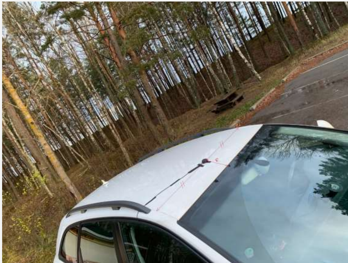
GPS ārējās antenas uzstādīšana uz Audi A4 allroad
